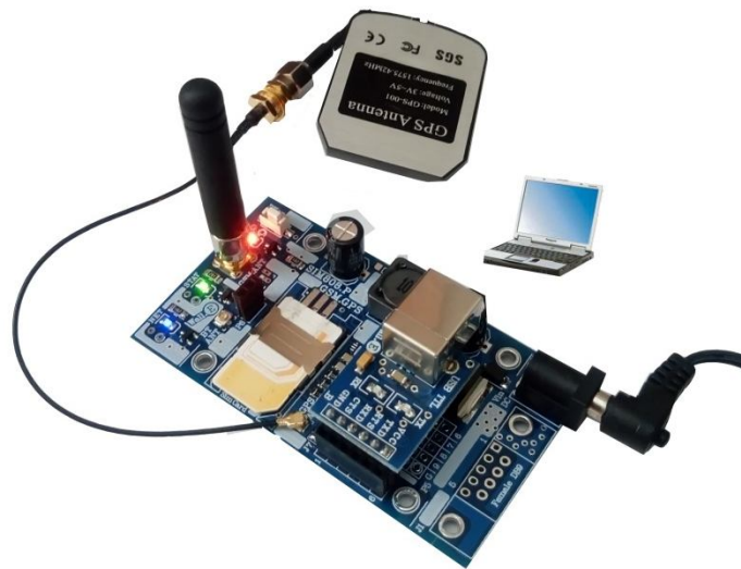
شکل 7: اتصالات برد توسعه برای ارتباط با جی پی اس
